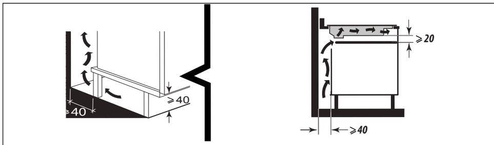
ou au-dessus d'un four encastrable, respectez les dimensions notées sur les illustrations afin d'assurer une sortie d'air suffisante.
