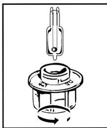
**Vous pouvez remplacer vous-même la lampe lorsqu'elle ne fonctionne plus.** Dévissez le hublot puis sortez la lampe (utilisez un gant de caoutchouc qui facilitera le démontage). Insérez la nouvelle lampe et replacez le hublot.
