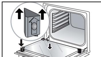
Après nettoyage, repositionnez les quatre butées caoutchouc flèche vers le haut et repositionnez l'ensemble des vitres.
