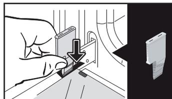
Retirez la première vitre clippée : A l'aide de l'autre cale (ou d'un tournevis) appuyez dans les emplacements **A** afin de déclipper la
