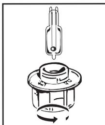
**Vous pouvez remplacer vous-même la lampe lorsqu'elle ne fonctionne plus.** Dévissez le hublot puis sortez la lampe (utilisez un gant de caoutchouc qui facilitera le démontage). Insérez la nouvelle lampe et remplacez le hublot.
